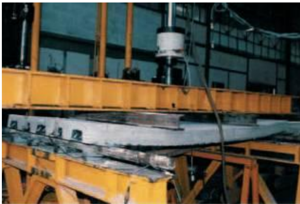
Рисунок А.2 – Вид образца сталежелезобетонной плиты в процессе испытаний
